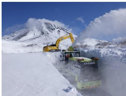
ロータリ除雪車による作業状況
