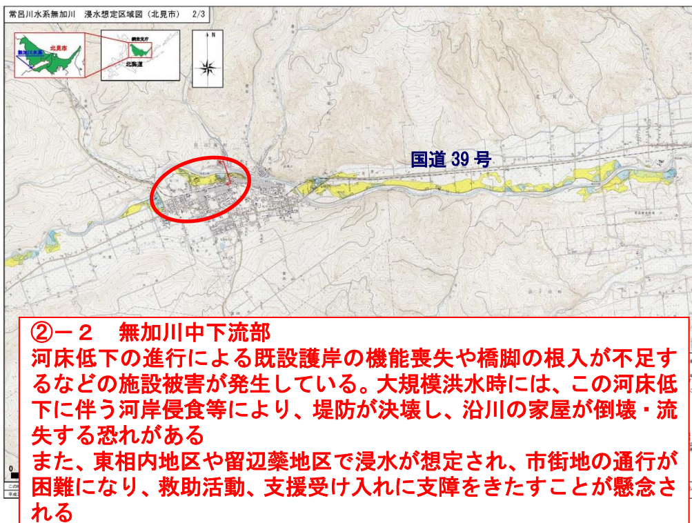
図 想定される被害の特徴 （常呂川水系 無加川（道管理区間））
