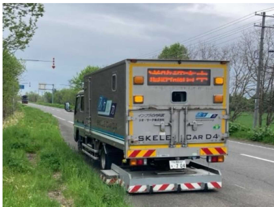
路面下空洞調査状況
