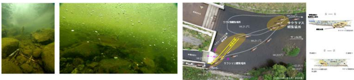
発電放流の泡を避けるように魚道入口に誘導されたサクラマス（②－②断面）
