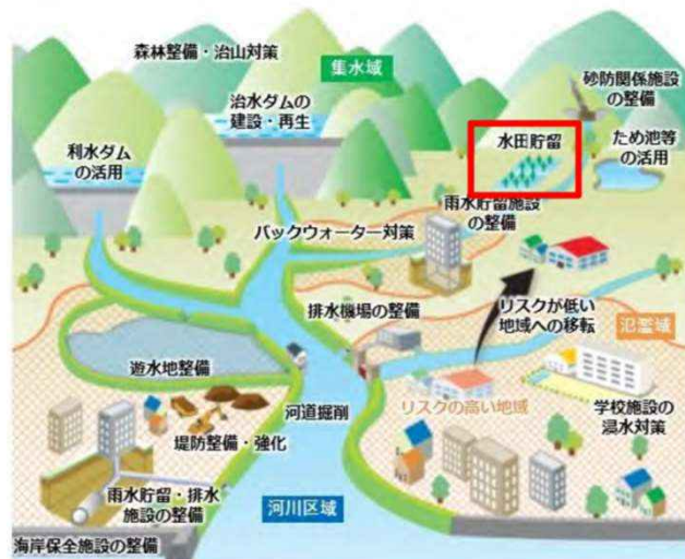
あらゆる関係者が協働して行う「流域治水」 資料：国土強靱化年次計画2021（国土強靱化推進本部）
