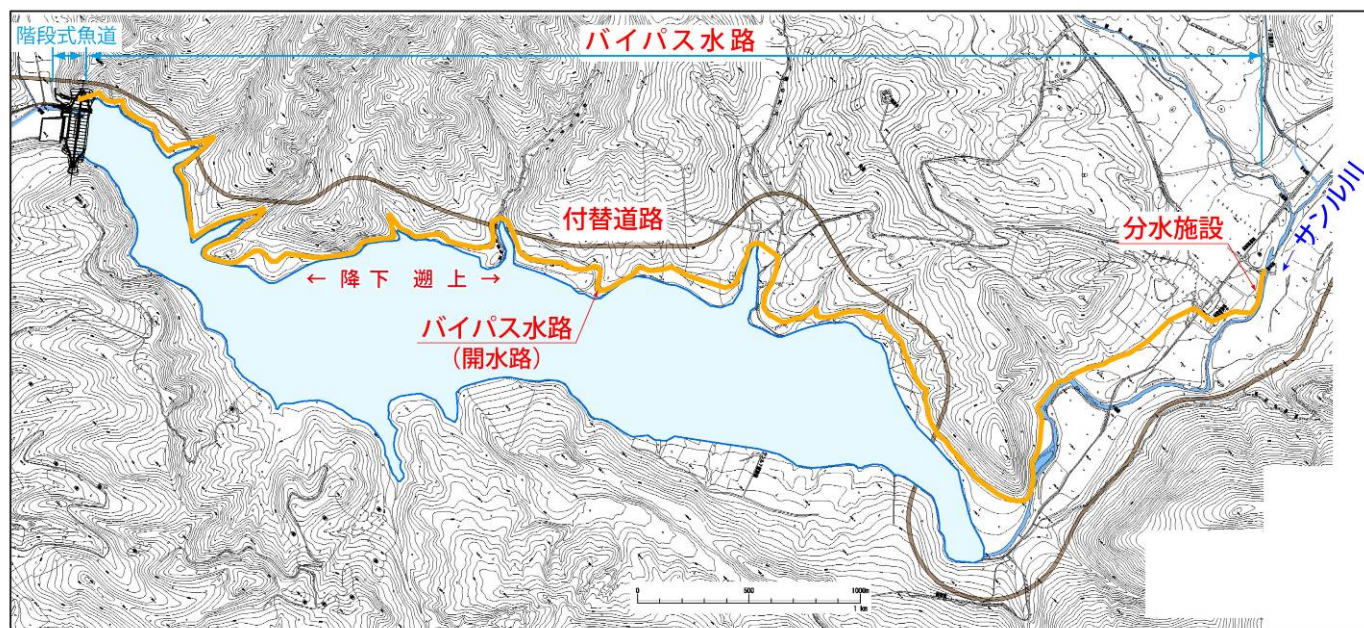
図-55 サンルダム魚道の概要
