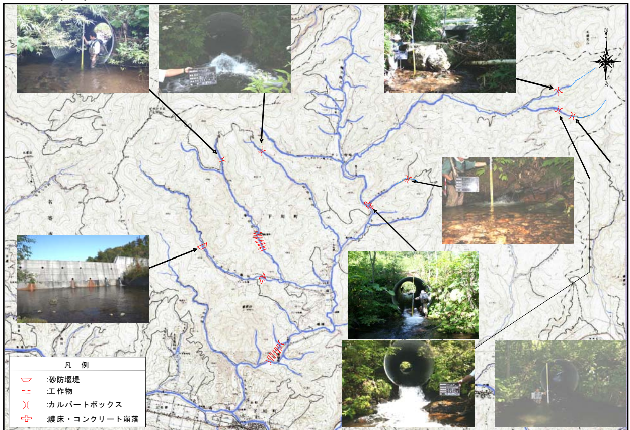
図-43 サクラマスの遡上が困難な河川横断工作物（サナル川上流域）
