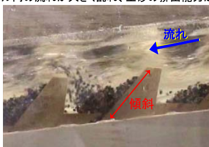
図-51 魚道の本体構造 (第1・3回魚類専門家会議 安田陽一委員提供資料)
