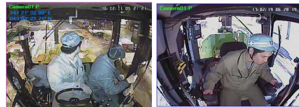
二人乗り 一人乗り（ワンマン） 図-1 除雪グレーダの運転室内状況
