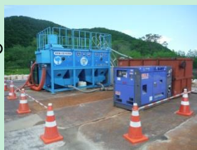
▼濁水処理装置
