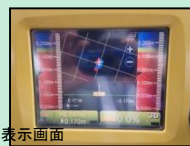
▲マシンコントロールによる土砂敷均作業
