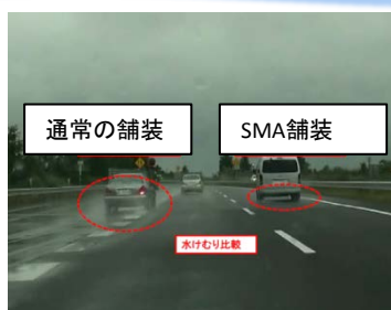
▲雨天時の舗装の比較
