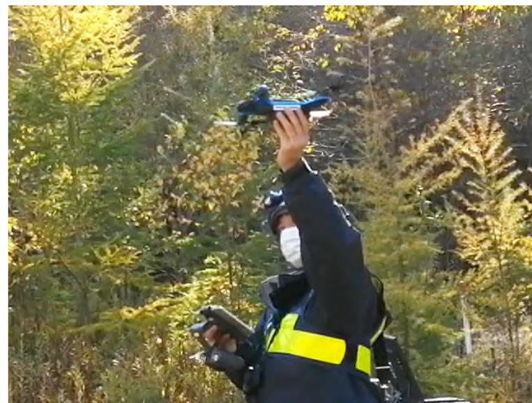
小型ドローン技術を用いた実機での実演講習を行います。確認が難しい橋梁の狭小部(河川内橋脚上の支承撮影等)撮影を行い、撮影動画をリアルタイムでモニターで確認し部材の状態を把握します。
