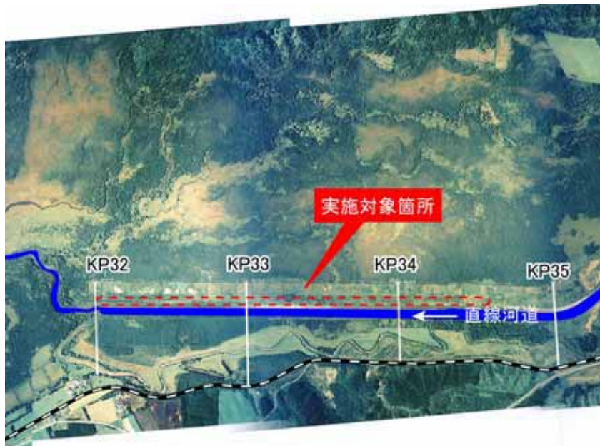
図 4-7 右岸残土の撤去区間
