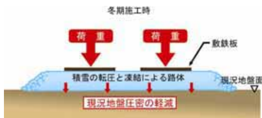
図 4-10 現況地盤圧密の軽減対策例
