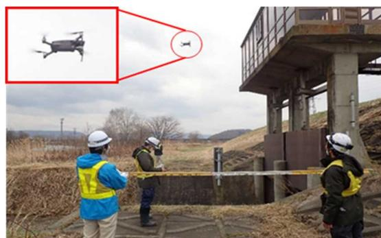
AI 技術による樋門等構造物の変状確認・評価
