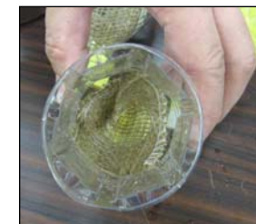
鉢底ネットの網目を通して土が落ちないことを確認する
