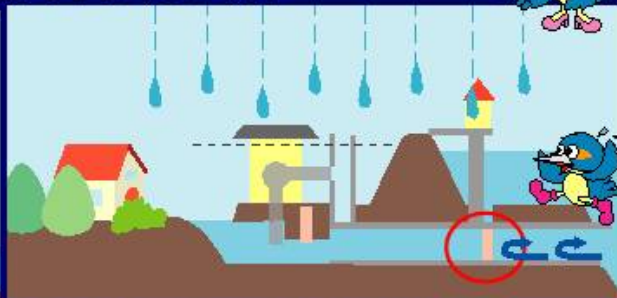
大雨の時1：水門を閉める (川の水を逆流させない)
