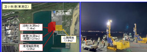
耐震性能を有する複合一貫輸送ターミナルの整備 【苫小牧港 東港区】 滑走路の液状化対策 【新千歳空港】
