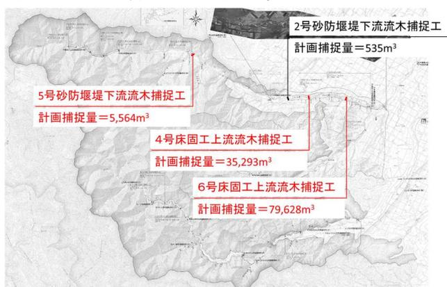
図-15 流木捕捉工の施設配置図
