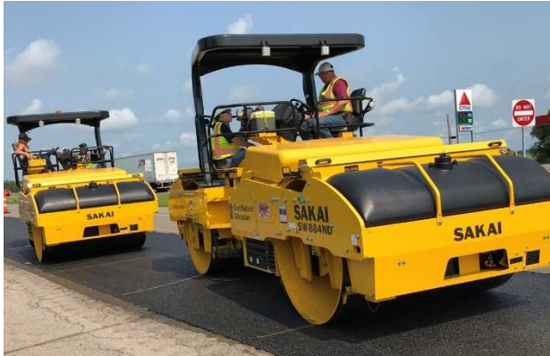
写真-2 米国で使用されている水平振動ローラの一例 (機械重量：約13t, 転圧幅：約2.0m)
