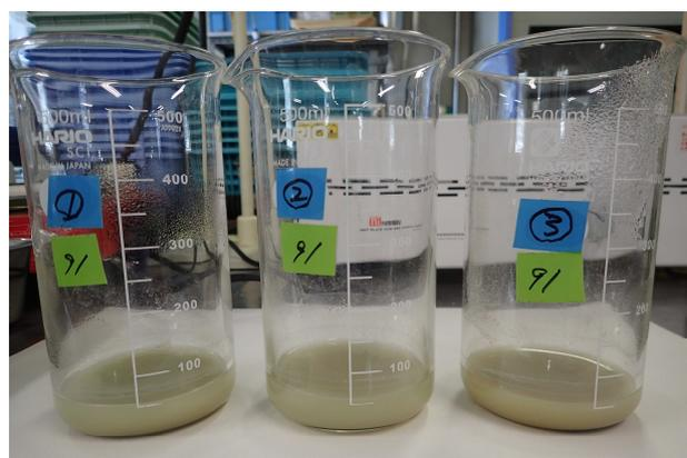
写真-3 加熱終了後のオキシドールとの反応状況
