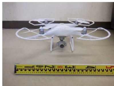
写真-1 空中写真測量に用いたドローン (DJI Phantom 4 Pro V2.0)
