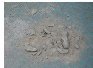
写真-5 床版抜け落ち箇所近傍のNo.1コア採取状況
