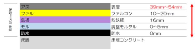
図-8 舗装復旧断面図
