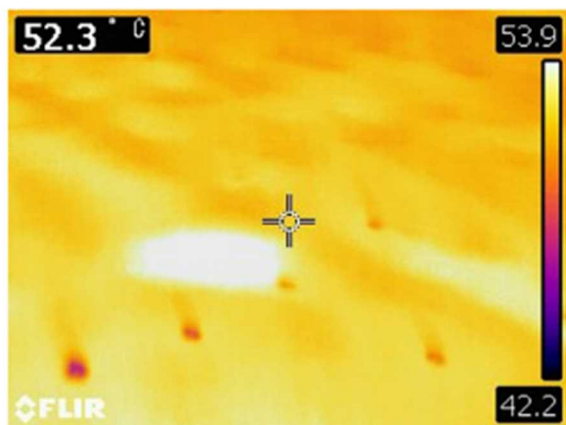
写真-5 転圧によりブリスタリングが移動
