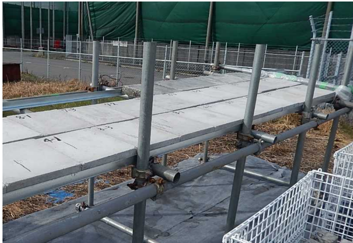
暴露試験状況
