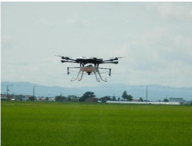
写真-3 ドローンによる防除・除草剤散布の活用状況
