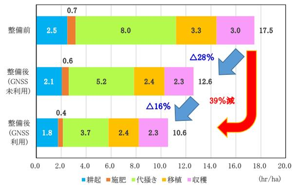
図-4 水稻機械作業時間の整備前後の比較
