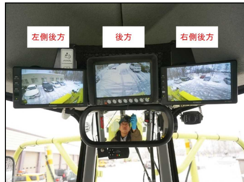
写真-10 後方モニター (CAT製仕様)
