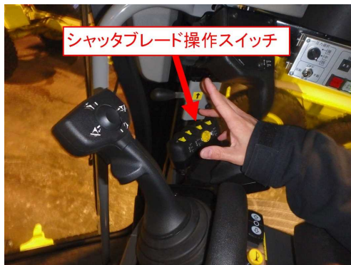
写真-8 シャッターブレード操作スイッチ (CAT製)
