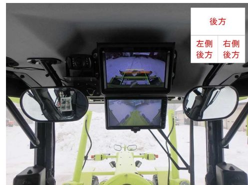
写真-9 後方モニター (コマツ製仕様)
