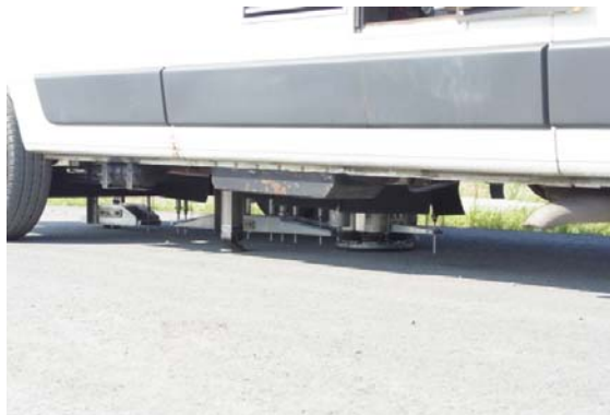
写真-5 FWD試験装置設置状況
