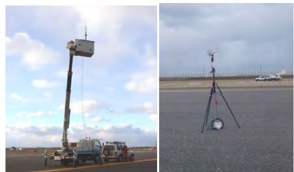
写真-5 移動気象観測(風向・風速)
