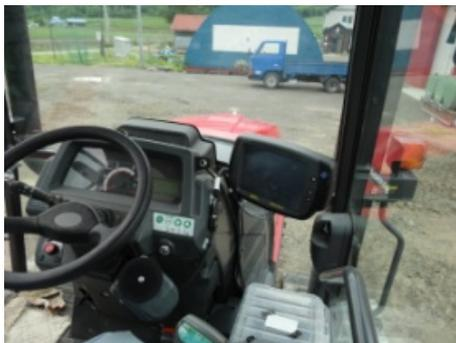
写真-2 GPS受信装置付トラクタ
