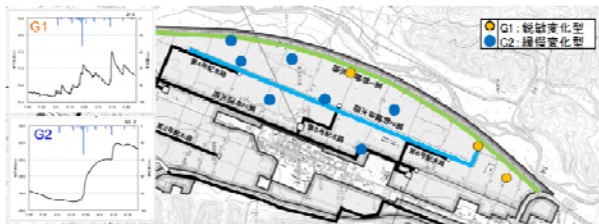
図-6 第1幹線排水路内 流量観測
