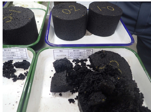
写真-8 供試体 (60度の温水養生で供試体が崩れた状況)
