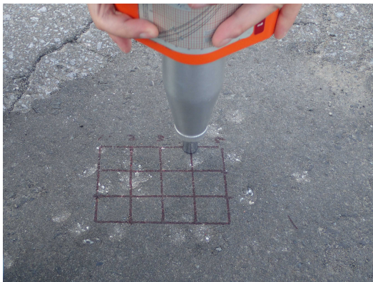
写真9 屋外圧縮強度試験実施状況
