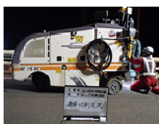
写真-6 通常の切削ブレードを装着した切削機
