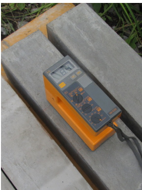
写真-6 シラン塗布時の打設面における表面水分率 (ケース1、H4-5 : 8.4%、4-5 : 5.3%)
