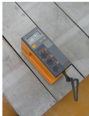
写真-6 シラン塗布時の打設面における表面水分率 (ケース1、H4-5 : 8.4%、4-5 : 5.3%)
