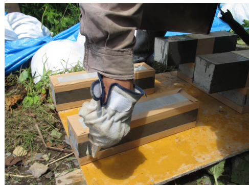
写真-3 塗布状況（ケース2）
