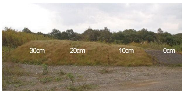
写真-3 高含水不良土を施工した箇所の植物の状態
