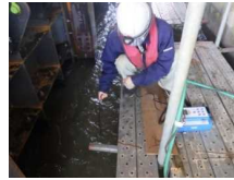
濁度測定状況(鰐川橋P1P2耐震補強工事)
