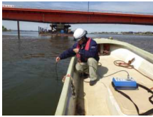
濁度測定状況(鰐川橋P1P2耐震補強工事)
