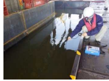
濁度測定状況(鰐川橋P1P2耐震補強工事)
