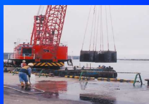
暴露した試験体の引揚げ
