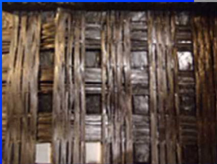
補強芯材(強化型) 上載荷重を分散
