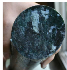
鏡肌となっている地すべり面下盤
