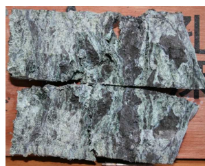
完全に粘土化した地すべり面上盤
