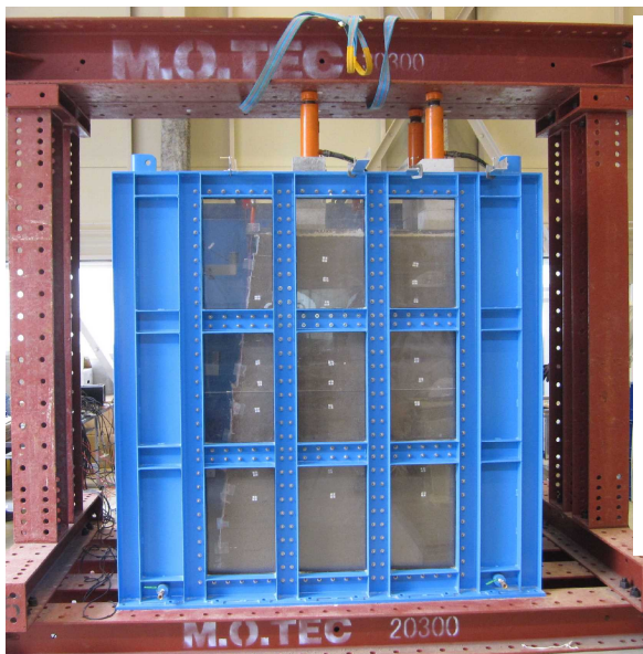
TMS載荷試験状況
