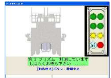
マシン姿勢測定用プリズム (3箇所) 自動追尾測量機 ナビ画面表示
