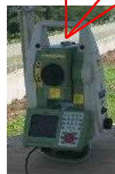
マシン姿勢測定用プリズム (3箇所) 自動追尾測量機 ナビ画面表示
