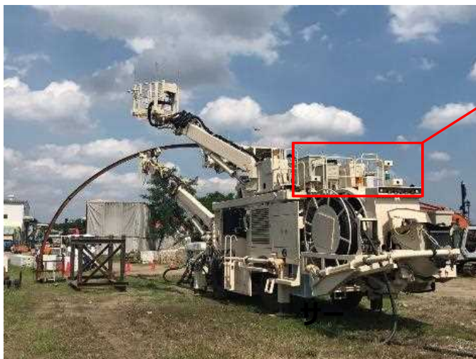
マシン姿勢測定用プリズム (3箇所) 自動追尾測量機 ナビ画面表示
