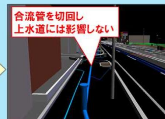
③合流管切回し工事
