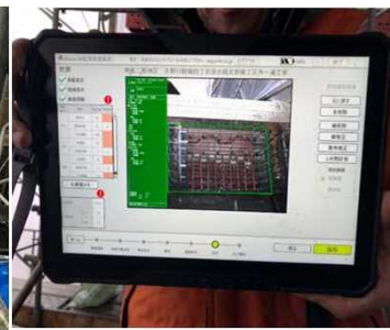
AI配筋検査端末 (左：配筋撮影状況 右：端末画面)
