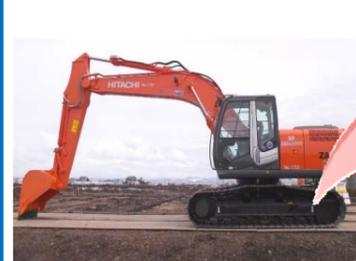
アームスピードの速い新技術バックホウの採用により、燃料消費量削減によるCO<sub>2</sub>削減、工程短縮も併せて実現
