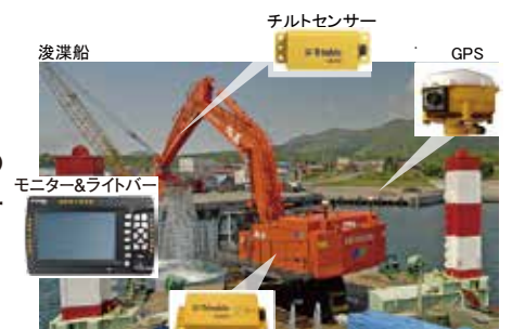
■バックホウ浚渫システム構成図
