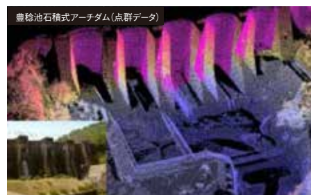
豊稔池石積式アーチダム(点群データ) ■構造物・文化財分野での活用
