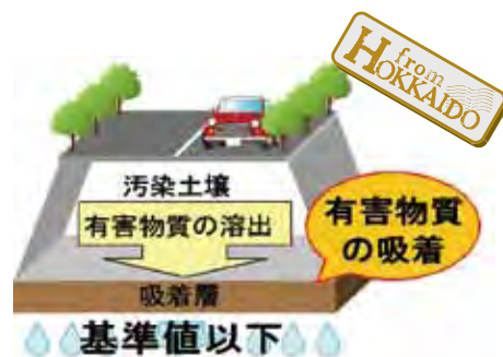
■吸着層工法の概略
