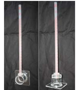
■現場吸水試験器（左：壁用 右：水平部用）
