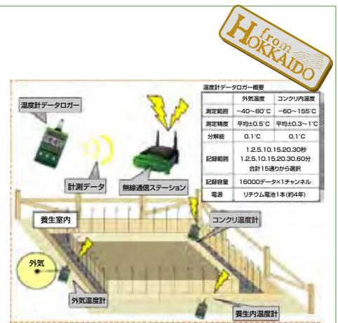
■モバイル式コンクリート養生温度管理システム
