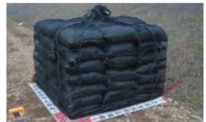
■耐候性土のう中詰め
