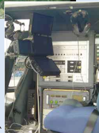
写真-2 航空機内の航空レーザ計測システム
