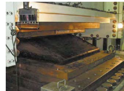
■せん断変形性能試験
