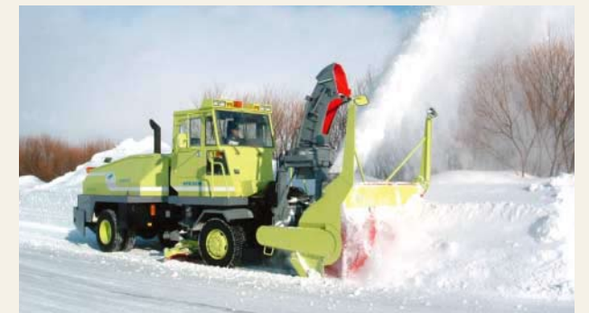
■写真-4 ロータリ装置とグレーダ装置の同時施工
